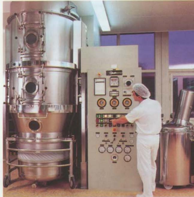
Ca. 40 Mio. Arzneimittelpackungen verlassen jährlich das Werk in Wehr. Produktion und Verpackung erfolgen mit modernsten Anlagen: Links die Herstellung von Mischungen im Wirbelschicht-Granulator als Vorstufe zur Tablettierung, rechts die Produktion von Salben.
