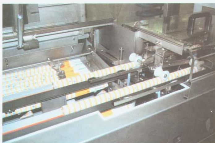
Die Salben-Füllstation wird mit konischen Leertuben beschickt. Neun dieser neuen Tuben beanspruchen heute bei der Lagerung den Platz von zwei zylindrischen Behältnissen, wie sie früher in der Salben-Produktion verwendet wurden. 75 % der Packmittel und des Lager-volumens ließen sich so einsparen.
